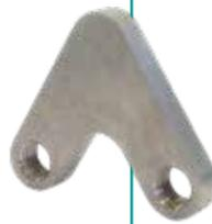
Zur vereinfachten Montage der Flanschverbindung unter beengten Verhältnissen in Straßenkappen bieten wir als Zubehör Konterlaschen an. Eine Konterlasche ersetzt dabei 2 Muttern, so dass ein Gegenhalten der Muttern unterhalb der Flanschverbindung entfällt.
