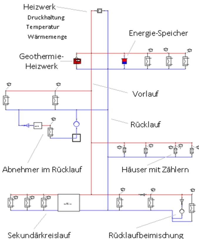
Nebenstehend ist eine Auswahl von wichtigen funktionalen Objekten. Diese Auswahl, zusammen mit allen weiteren Werkzeugen sind die Grundlage für die Modellierung eines „digitalen Zwillings“ des Fernwärmenetzes. Dabei werden alle die Objekte integriert, die unmittelbaren Einfluss auf die hydraulische und thermische Simulation haben. Für die Simulation des realen Betriebs lassen sich Steuerungen und Messdaten (Lastgang) einsetzen.
